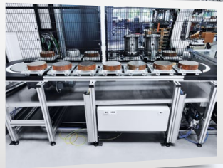
1. Zu- und abgeführt werden die Werkstücke über ein Umlauf-Lagersystem, das sicherstellt, dass sich die Teileausrichtung während der Bearbeitung nicht ändert.
