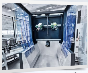
2. Zum Entgraten von Werkstücken nach der Bearbeitung auf einer der DMC-Fräsmaschinen steht eine Entgratstation zur Verfügung.
